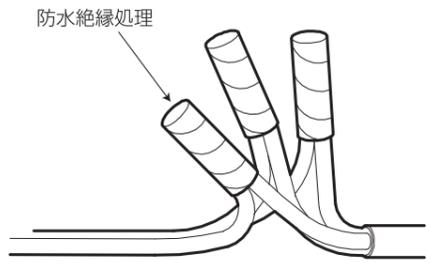
自己融着絶縁テープなどで口出し線結線部の防水絶縁処理を施した後、防水絶縁処理の先端を上(天井側)に向ける。
